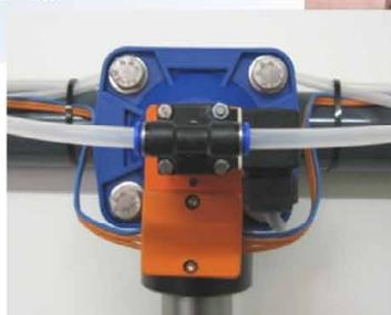
Ædetidsstyring skal ses som et nyt styringsredskab, som muliggør at selve arbejdsgangen med at justere foder ved de enkelte ventiler helt eller delvist overflødiggøres. Systemet kan med fordel benyttes i farestalde samt ved restriktiv - (1 gris/ædeplads) og sensorfodring (2 grise/ædeplads) af smågrise og slagtesvin.
