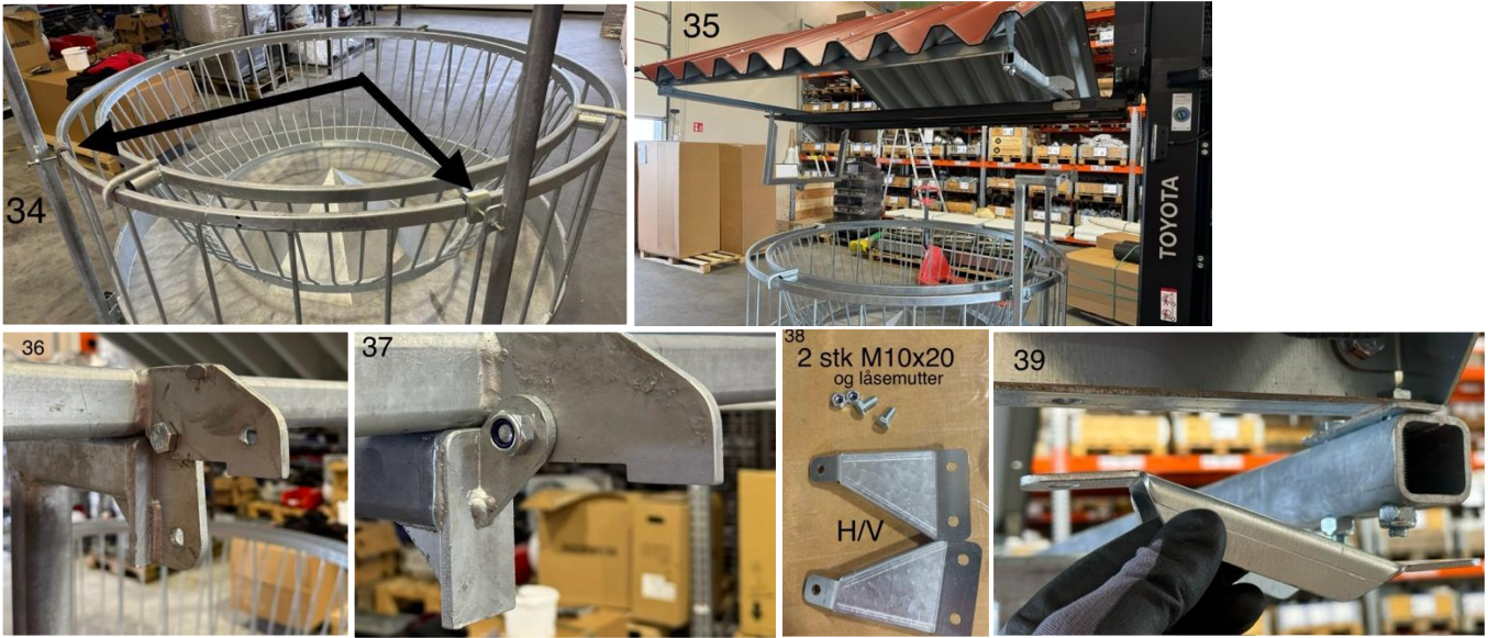
Bilde 36&37 Fest med M10x20 bolt og låsemutter, skal ikke ver for stramt.
